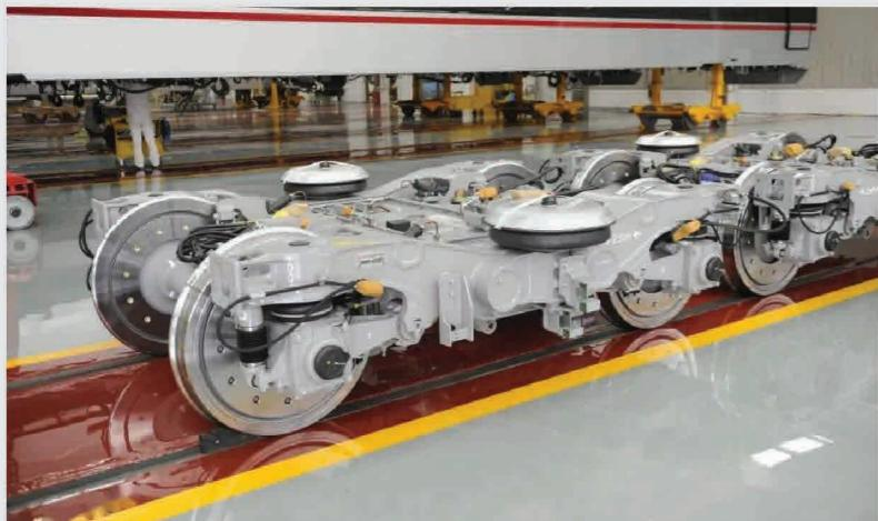
动车组转向架就是由车底的轮子和支架，减震，制动等一系列部件的合成。简单说，转向架是列车车身与车轮之间的连接部件，属于车底走行系统的重要组成部分，并作为一个独立的走行装置，它具有支承车体、承受车辆的全部重量及作用在车辆上的其他方向的作用力（如横向风力、离心力、纵向车辆牵引力和列车冲击力等）。总之，在列车的运行过程中，转向架承受的力是最复杂的。还包括了线路对车体的冲击和振动；轮轨间的摩擦阻力；车轮的蛇形运动抗力等等；而牵引力和制动力的最终实现，都集中在这个底架上。
