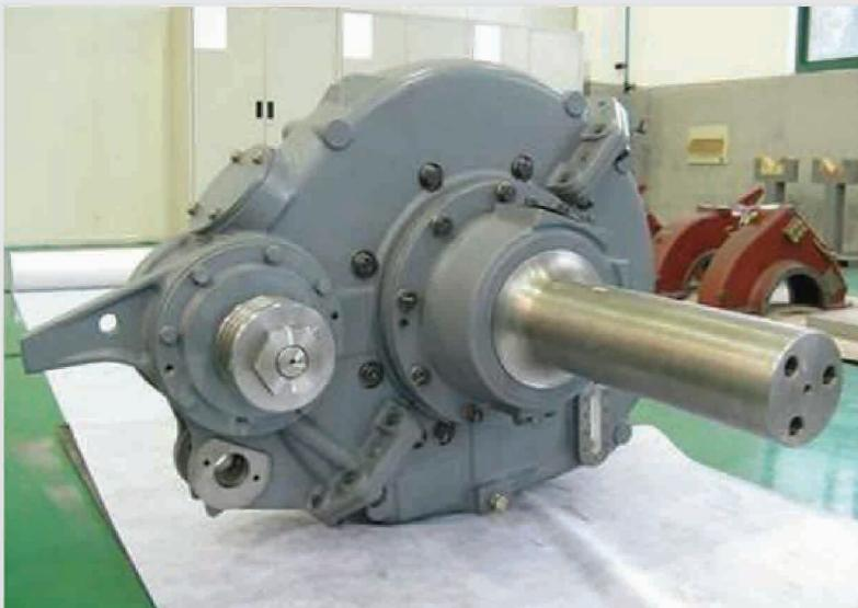
高铁机车齿轮油处在一个高温高压的工作环境下。高铁机车运行速度快，其齿轮传动比较大，使润滑油的粘度范围被极大地限制。传动系统传递的扭矩越大，而传动齿轮受到的载荷也越大，尤其是当车辆颠簸震动时，传动齿轮会受到极大的冲击载荷。除此以外由于较大的齿轮传动比，小齿轮转速大，齿轮轴温升也会很快。
