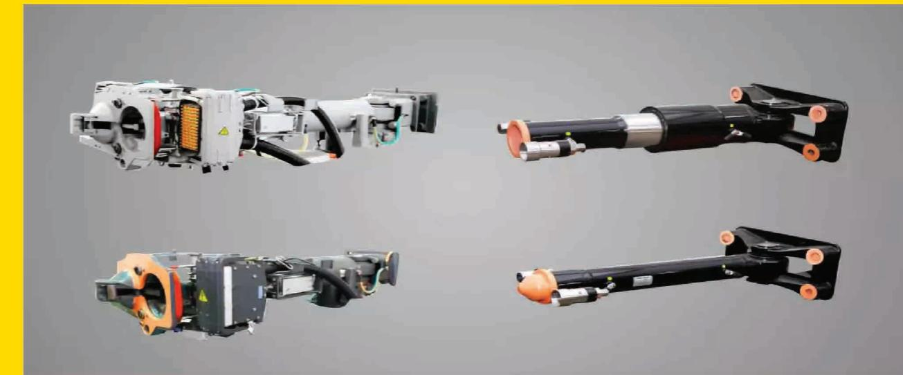
自动钩缓装置可以最大限度地减小纵向链接间隙，使列车的纵向冲动水平大大下降，极大提高列车舒适性和安全性。同时，可以在列车连挂和分解时，自动控制相邻两车动力、辅助、通讯电路和空气管路的通断。
