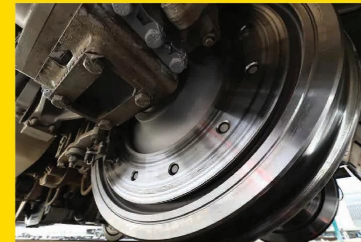
当动车组速度很低，即将停站时，再生制动的效果比较差，就会改为盘形制动。或者是在接触网因故障停电时，以及其他需要触发紧急制动情况下，就会使用盘型制动。这个与汽车上的制动盘工作原理一样。车轴上套上2到4个制动盘，或者是两端的车轮一部分作为制动盘，卡钳和其抱住，摩擦发热，从而将动车组的动能转变为热能消散掉，达到减速的目的。盘式制动也称之为安全制动，确保动车组紧急情况下能够安全停车。
